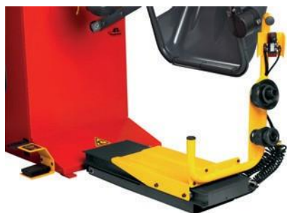
Професионален асансьор за повдигане на колелата до 80 кг
