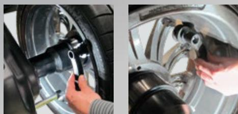
Acquisizione automatica della distanza e del diametro.
