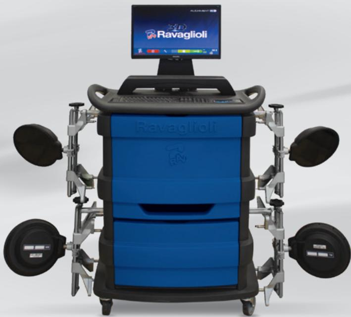
La serie TD3200 rappresenta la seconda generazione degli assetti ruote 3D Ravaglioli. Il suo innovativo sistema di telecamere 3D interamente wireless con trasmissione Bluetooth può essere utilizzato su diverse tipologie di ponti grazie ad una compensazione automatica della planarità; le sue dimensioni compatte lo rendono inoltre adatto anche a quelle officine con spazio limitato.
