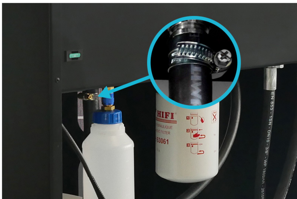
Figura 25. O clemă folosită pentru a regla lungimea conductei de aspirație.
