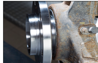
Figura 3: Inelul de blocare trebuie să fie la același nivel cu fuzeta de direcție
