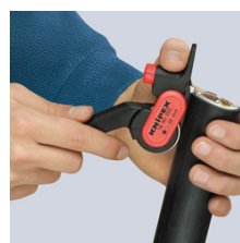
Τοποθέτηση του εργαλείου για απογύμνωση κατά μήκος
