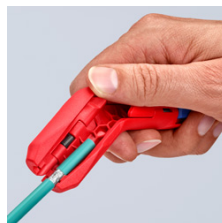
Skidanje plašta podatkovnog kabela
