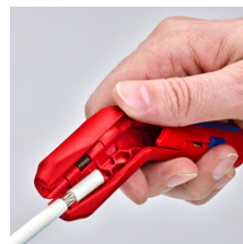
Skidanje plašta koaksijalnog kabela
