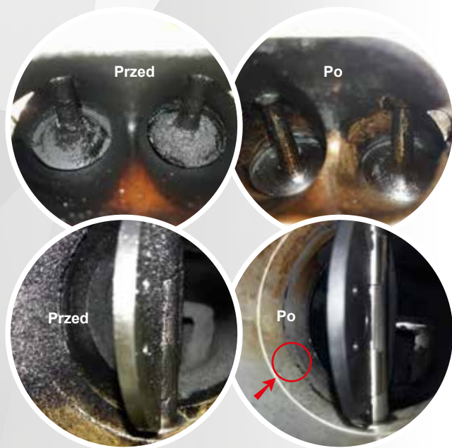
Zdjęcie zaworów dolotowych (górze) i przepustnicy (dół).
