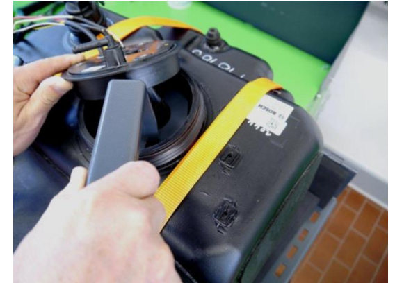
Demontaż pokrywy zasobnika/podgrzewacza
