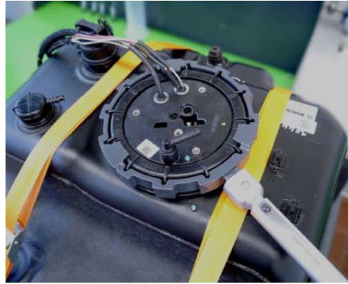
Odkręcenie nakrętki mocującej
