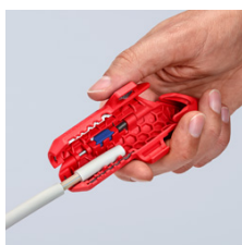
απογύμνωση ενός καλωδίου NYM
