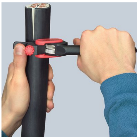
Obrócenie narzędzia do cięcia po obwodzie
