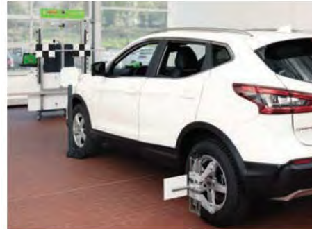
Přední radar + kamera Nissan: Softwarové měření vzdálenosti prokáže jeho plnou výhodu zejména při vzdálenostech 2 až 4 metry. To zvýší efektivitu autoservisu. Pomůcka pro měření vzdálenosti s ukazatelem pro referenční polohu středu kola.
