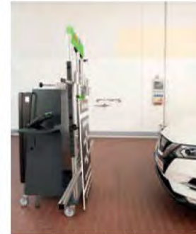
3bodová kalibrace radaru: Naklápěcí pozice podle požadavků z prvovýbavy: +2°, 0°, -2°
