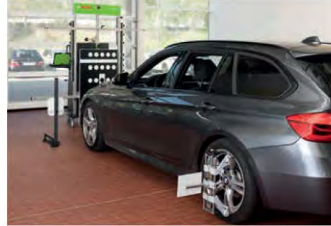
BMW/Mini a VW Group: Vysoce přesné umístění na geometrickou jízdní osu včetně specifického nastavení vzdálenosti. Kalibrační terče VW nastavte svisle a na střed před radarové čidlo.
