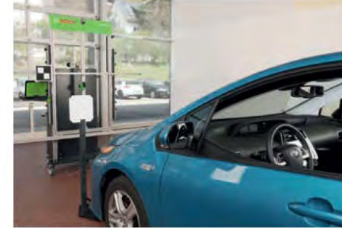
Přední kamera Toyota: Sekvenční kalibrace s jedním nebo více terči. Vysoce přesné umístění pomůcky pro měření vzdálenosti podle požadavků pro prvovýbavu.
