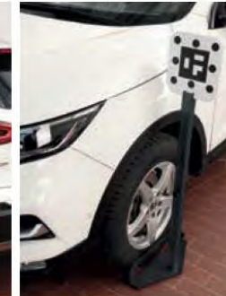
Přední radar + kamera Nissan: Softwarové měření vzdálenosti prokáže jeho plnou výhodu zejména při vzdálenostech 2 až 4 metry. To zvýší efektivitu autoservisu. Pomůcka pro měření vzdálenosti s ukazatelem pro referenční polohu středu kola.
