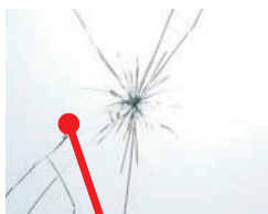
Uszkodzona szyba przednia
