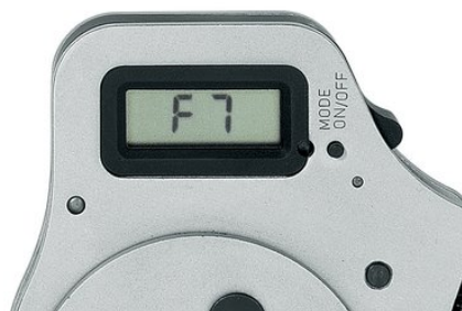
Wielofunkcyjny wyświetlacz cyfrowy, możliwość ustawienia parametrów zagniatania w mm, w calach, a także zgodnie z MIL
