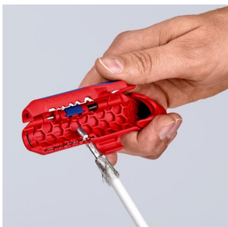
Usuwanie izolacji z kabli koncentrycznych
