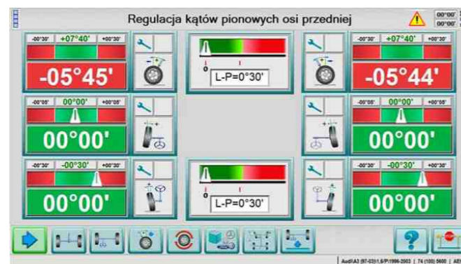
Regulacja parametrów osi przedniej z automatycznym pomiarem pojazdów ze spojlerem.
