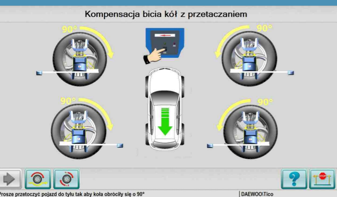
Kompensacja przez przetaczanie pojazdu.
