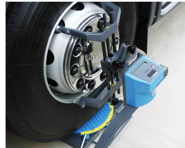
Zespół pomiarowy zamontowany na zacisku z kompensatorem 14"-24".
