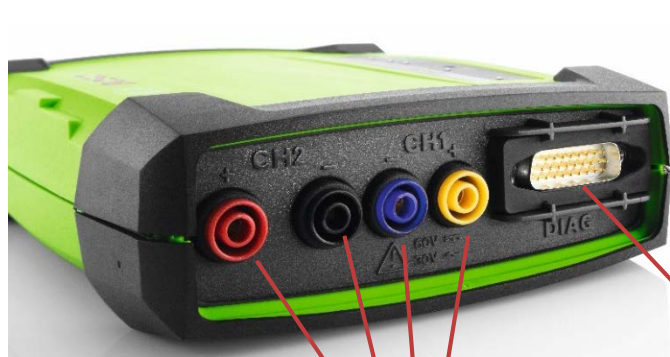
Vstupy měřících vedení pro multimetr a osciloskop
