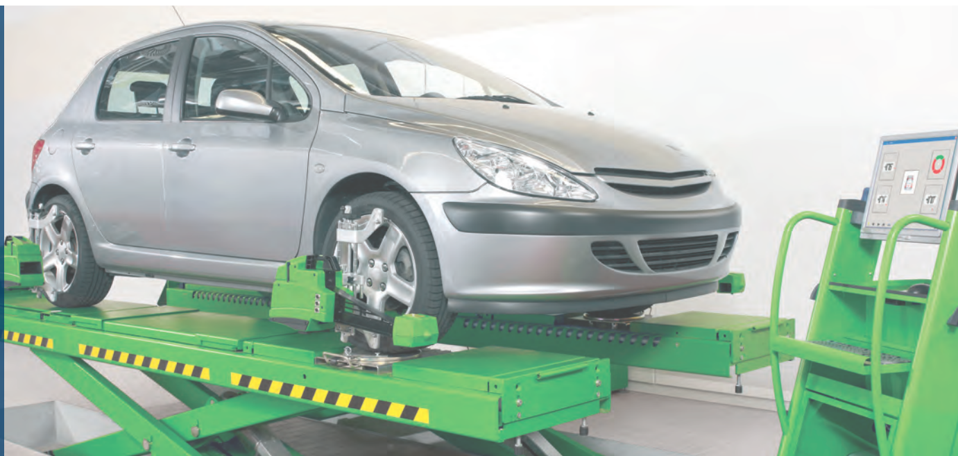
Niezakłócony pomiar kątów za pomocą głowic z kamerami CCD
