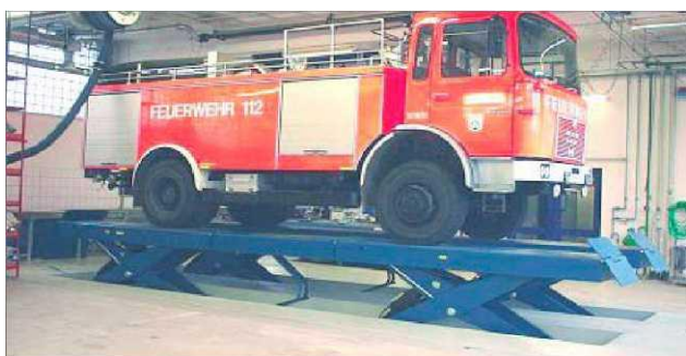
Całkowita długość platformy najazdowej uzależniona od zestawienia modułów i opcji może wynieść 23000 mm
