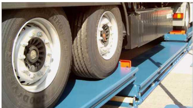
Adaptory mogą być odblokowane i pozostać na ziemi dla lepszego dostępu do pojazdu
